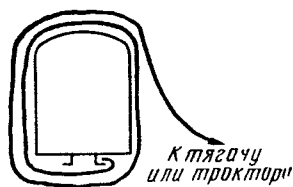
Рис. 44 Способ стропки подвижного состава для его двойного опрокидывания одним канатом
