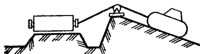
Рис 47 Использование дополнительного ролика при вытаскивании подвижного состава (груза) тяговыми средствами из выемок
